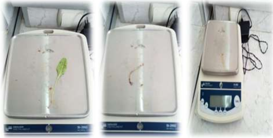
الشكل (16): قياس الوزن الغظ لكل من الجزء الخضري و الجذري بواسطة الميزان
