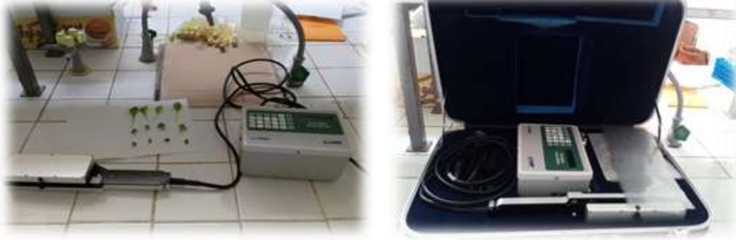
الشكل (14): جهاز Portable Area Mètre
